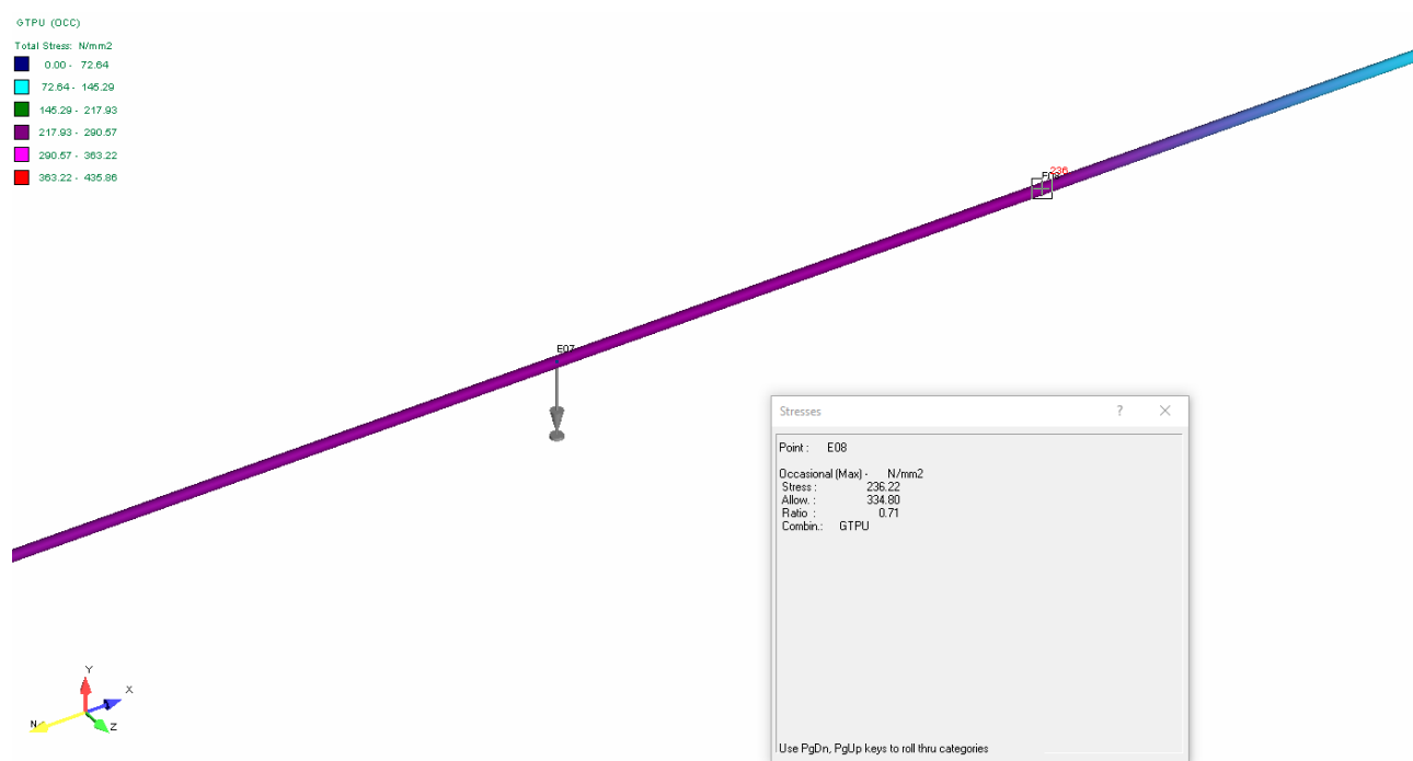
Рисунок 8 – Картина распределения напряжений по Мизесу в районе 50+60 (с применением теплоизоляции)
