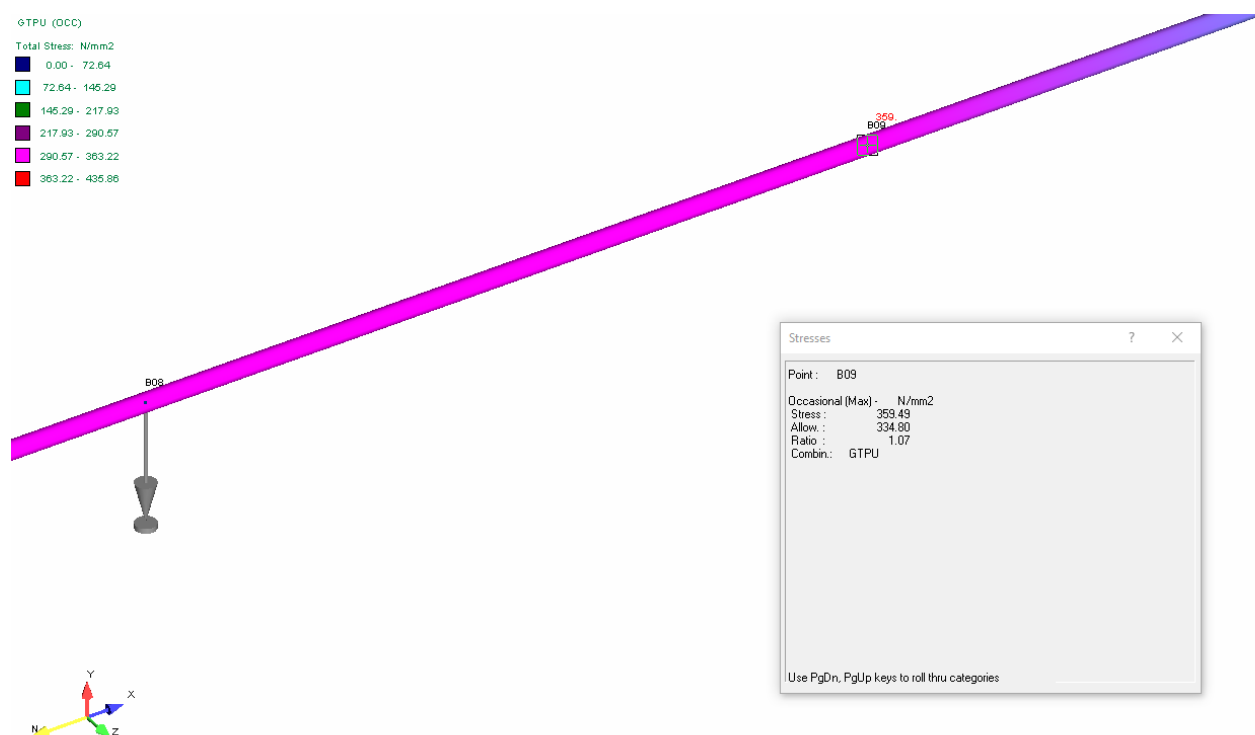
Рисунок 5 – Картина просадки в районе выхода с площадки узла запуска СОД на КП10
